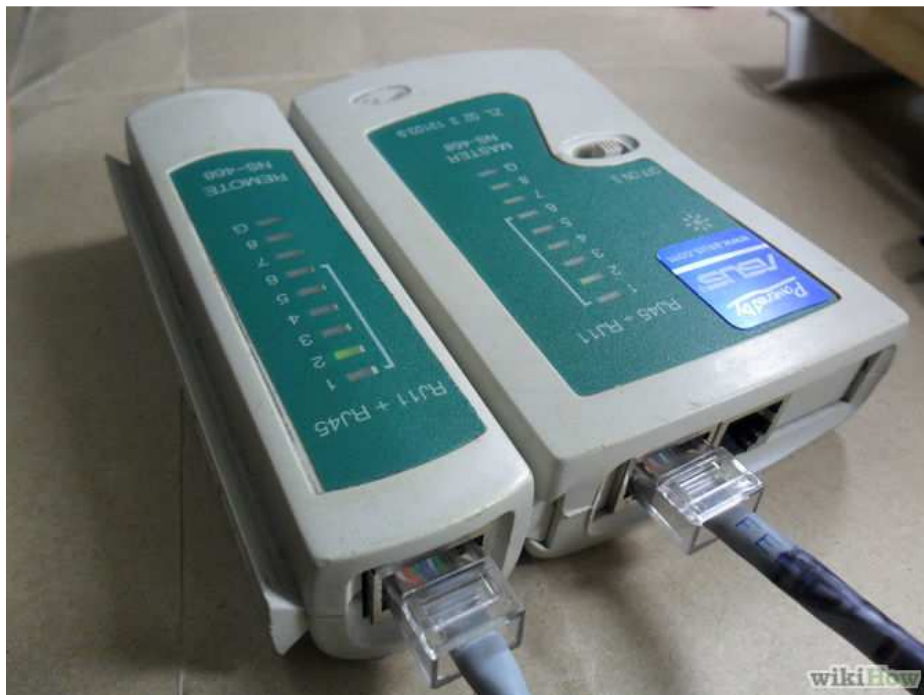
Figura 11 - Tester di cablaggio.
